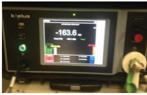
图2. 带有PIM分析仪的高性能测试装置为不同电路层压板提供PIM值测试
