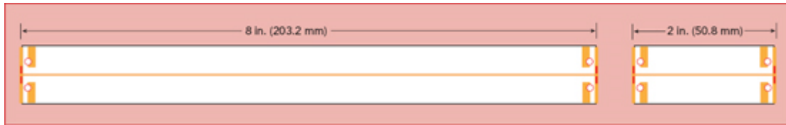
图 4 差分相位长度法中使用的长、短微带线电路
