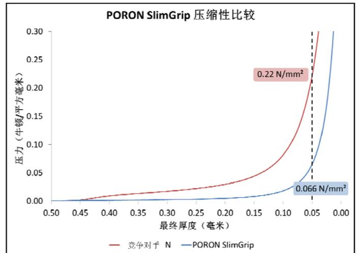
SlimGrip 泡沫有一层 0.05 毫米厚的可移除 PET 膜。当 PET 膜移除后，会露出一层带微粘性的表面，这样整个材料没有任何不可压缩层。该微粘性的表面有助于临时放置垫圈。
