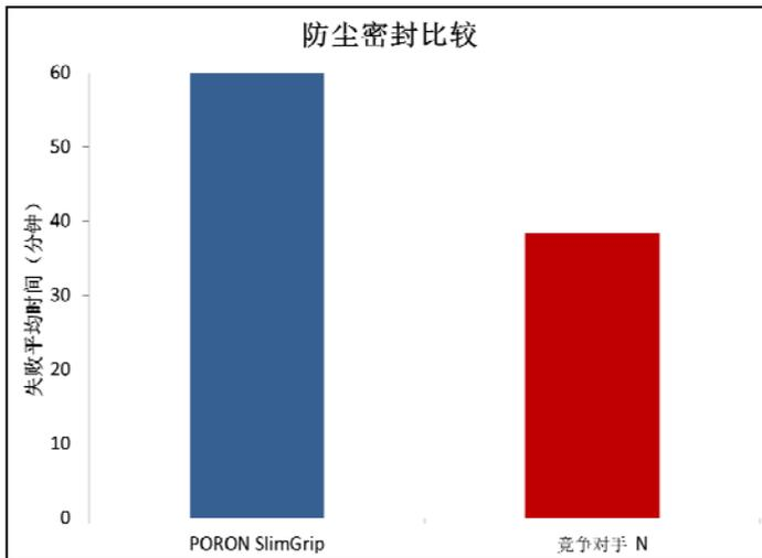
**注释：**测试材料作为垫圈的宽度是1毫米，压缩量为37%，放在一个充满灰尘的环境中翻滚。如果灰尘进入衬垫，材料则被视为“失败”。
